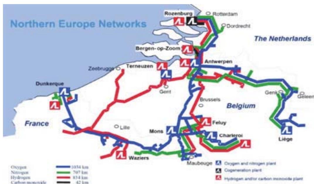
Fig. 35: Ondergronds leidingnet gassen (bron: Air Liquide)
